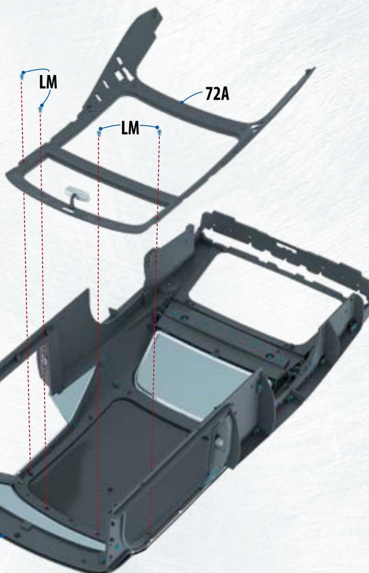
**72.2** **Разместите** раму **72А** на внутренней стороне средней части кузова **61А**, после чего вставьте четыре винта **LM** в указанные на фотографии отверстия и слегка закрутите их. Пока не закручивайте винты до конца: мы сделаем это в самом конце данного этапа сборки. ▶
