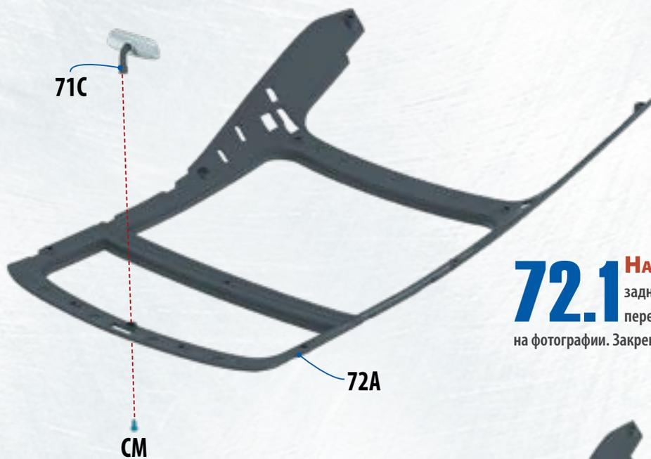
**72.1** **Наденьте** конец кронштейна зеркала заднего вида **71С** на центральный выступ передней части рамы **72А** так, как показано на фотографии. Закрепите его с другой стороны винтом **СМ**. ◀
