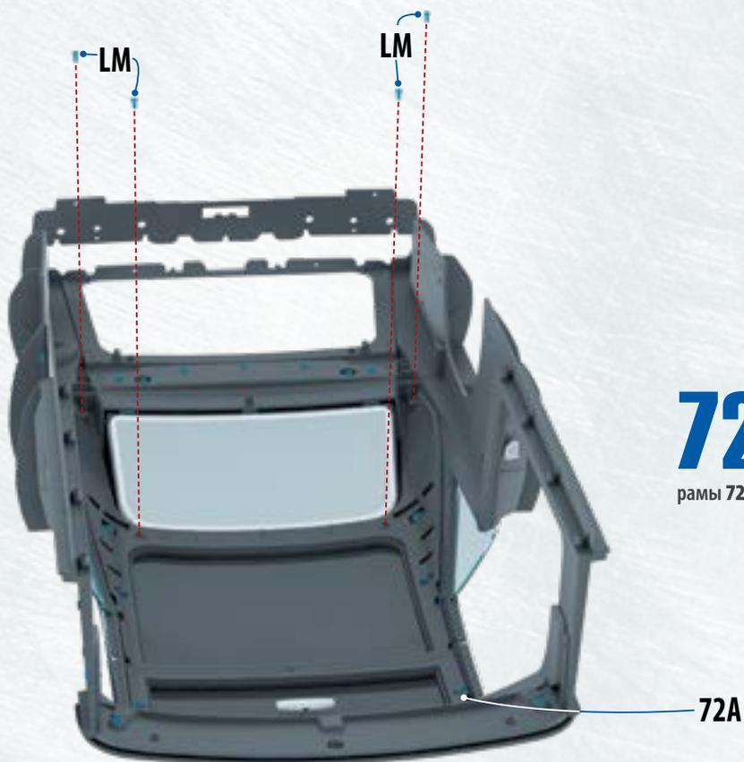
**72.4** **ВСТАВЬТЕ** последние четыре винта LM в указанные на фотографии отверстия рамы 72A и закрутите их наполовину. ◀
