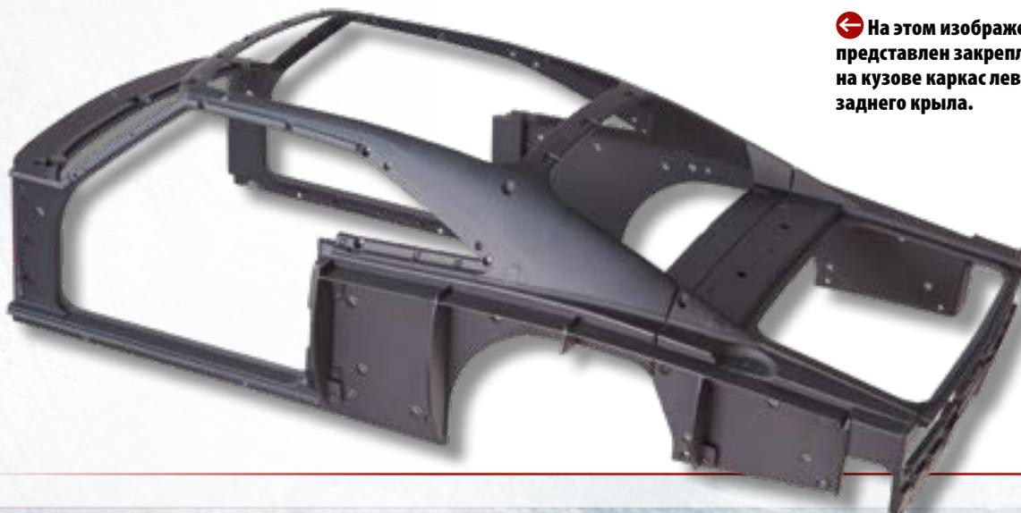
← На этом изображении представлен закрепленный на кузове каркас левого заднего крыла.
