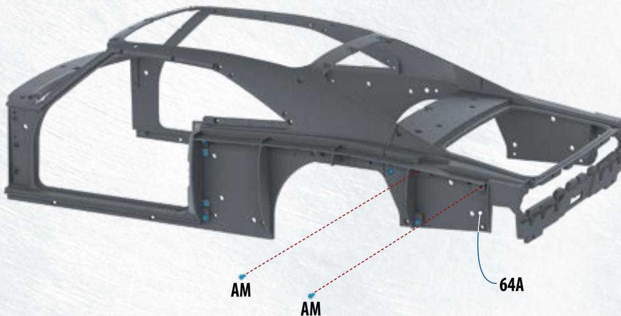
**64.4** ЗАВЕРШИТЕ МОНТАЖ каркаса 64А, закрутив два винта AM в указанные на фотографии отверстия в его задней части. ▲
