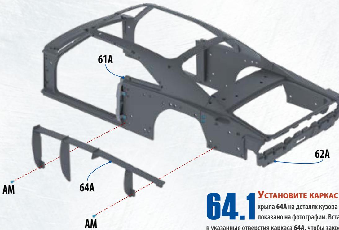
**64.1** УСТАНОВИТЕ КАРКАС левого заднего крыла 64А на деталях кузова 61А и 62А так, как показано на фотографии. Вставьте два винта АМ в указанные отверстия каркаса 64А, чтобы закрепить его.▲
