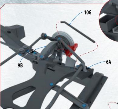
ОБРАТИТЕ ВНИМАНИЕ на то, что усилители 10G имеют изгиб. Возьмите одну из деталей 10G и вставьте ее короткую согнутую часть в небольшое отверстие детали 9B, после чего осторожно вставьте другой конец усилителя 10G в соответствующее отверстие детали 6A. ◀
