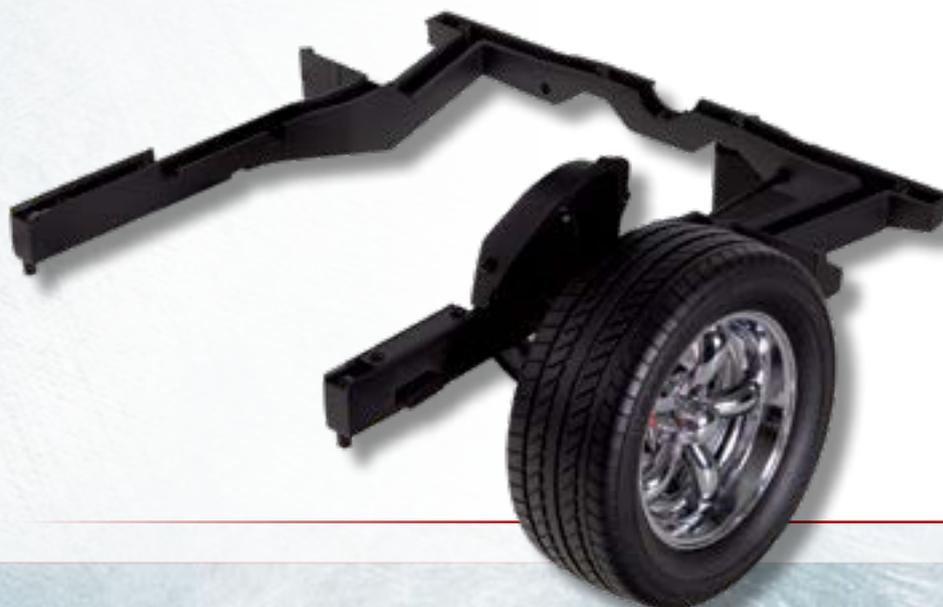
◀ Так выглядят колесо и его подвеска, собранные и закрепленные на передней части рамы.
