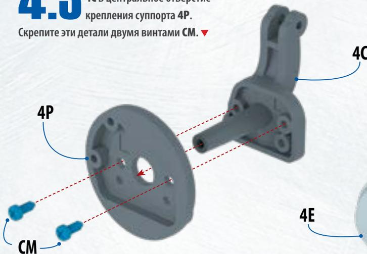
**4.4** **Вставьте ось детали 4C** в отверстие детали **4E**. Затем установите суппорт **4A** на собранной конструкции так, как показано на фотографии (крепёжные отверстия суппорта и детали **4P** должны совпасть). Закрепите установленный суппорт двумя винтами **CM**. ▶
