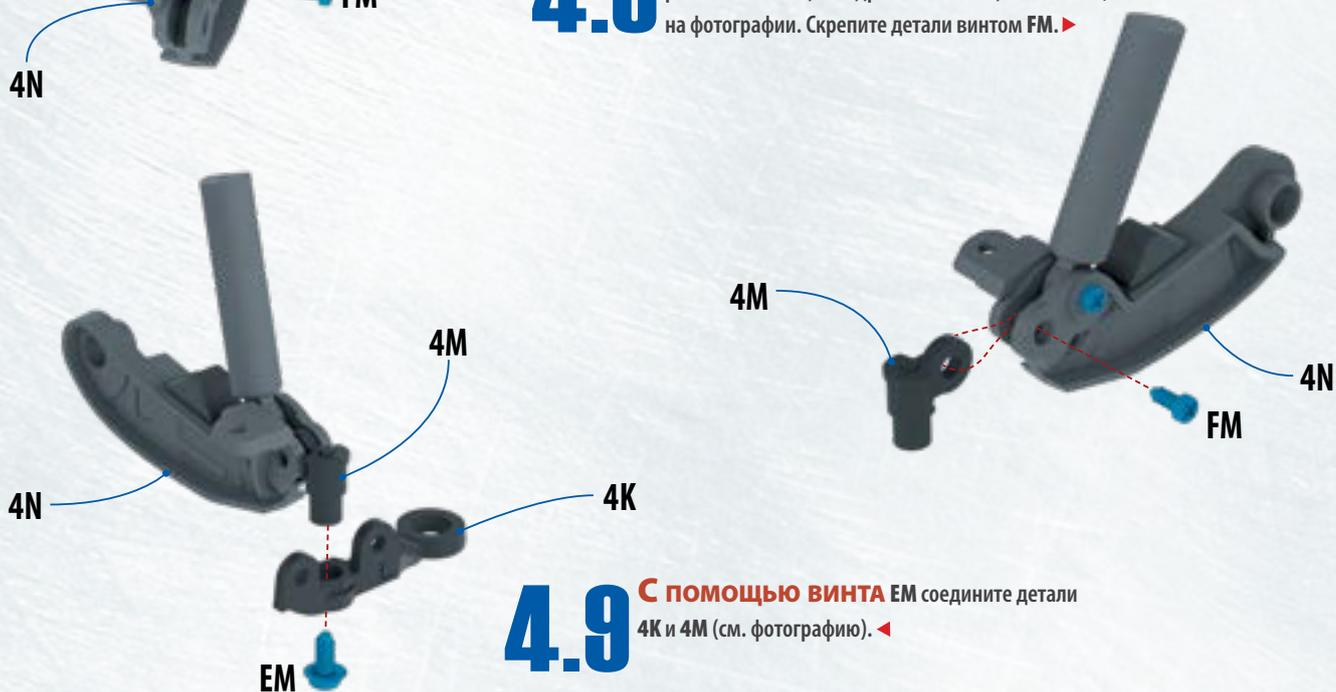
**4.9** С помощью винта EM соедините детали 4K и 4M (см. фотографию). ◀
