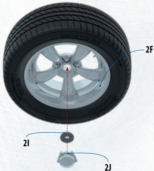
**2.6** С **ВНЕШНЕЙ СТОРОНЫ КОЛЕСА** (*outside*) вставьте в центральное отверстие детали **2F** прокладку **2I**. Установите поверх прокладки деталь **2J** и слегка надавите на нее, чтобы она вошла на свое место. ▲
