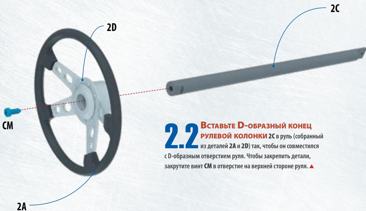
**2.2** Вставьте D-образный конец рулевой колонки 2С в руль (собранный из деталей 2А и 2D) так, чтобы он совместился с D-образным отверстием руля. Чтобы закрепить детали, закрутите винт CM в отверстие на верхней стороне руля. ▲
